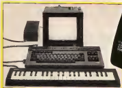
Mit dem kleineren Keyboard wird der CX-5 zusammengebauter Synthesizer
